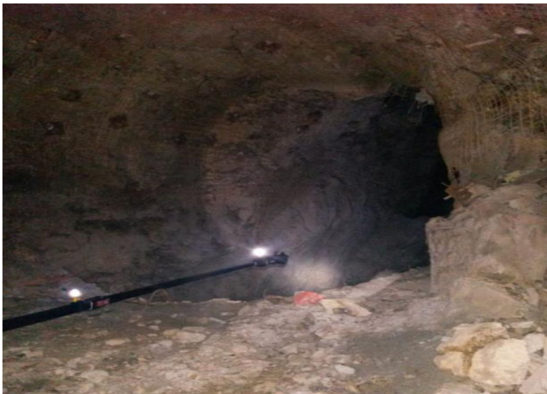
Рисунок 7 - Установка сканера в очистной камере.
